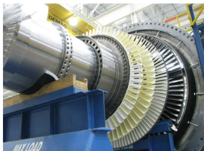
Gambar 4.4. Turbin gas pada PLTG
